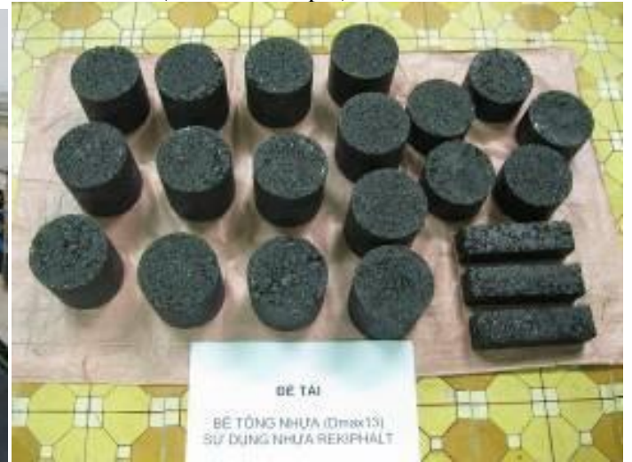
Thử nghiệm bê tông nhựa rỗng có sử dụng phụ gia TPS (TafPack-Super) Testing of hollow concrete with additives TPS(TafPack – Super)
