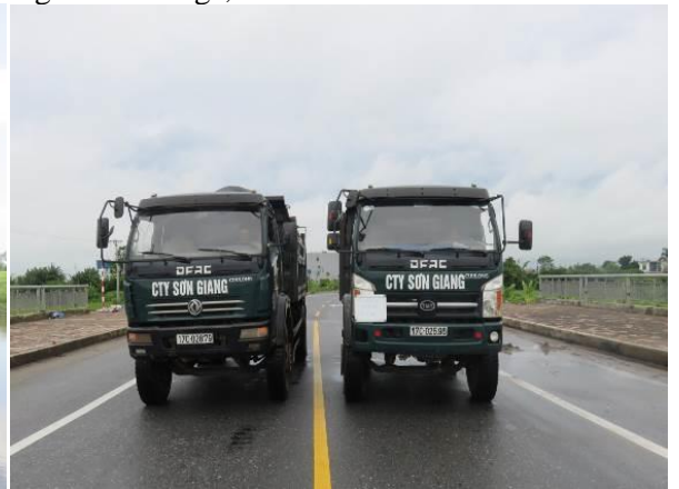
Thí nghiệm, kiểm định thử tải cầu sông T1 tỉnh Thái Bình Construction quality control, loading test of T1 River Bridge, Thai Binh Province
