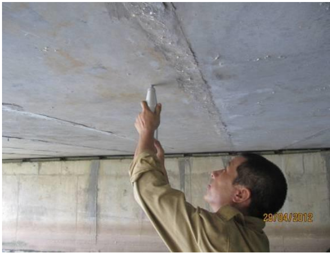
Thí nghiệm, kiểm định thử tải cầu Thôn Thịnh thành phố Nam Định Construction quality control, loading test Thon Thinh Bridge, Nam Dinh Province
