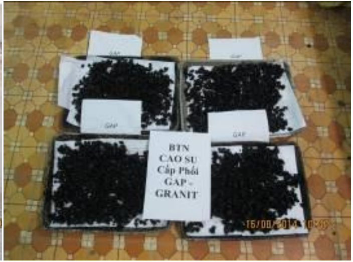
Thử nghiệm vật liệu nhựa đường cao su hóa Rubber Asphalt – RA Testing of Rubber Asphalt Material
