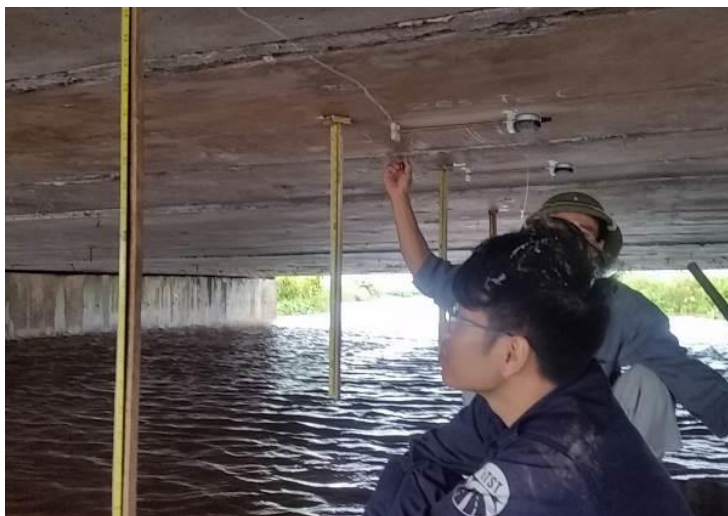
Thí nghiệm, kiểm định thử tải cầu An Bồi tỉnh Thái Bình Construction quality control, loading test An Boi Bridge, Thai Binh Province
