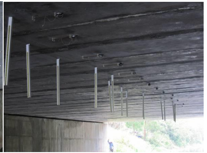
Thí nghiệm, kiểm định thử tải cầu Thôn Thịnh thành phố Nam Định Construction quality control, loading test Thon Thinh Bridge, Nam Dinh Province
