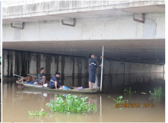
Thí nghiệm, kiểm định thử tải cầu Bùi tình Thái Bình Construction quality control, loading test Bui Bridge, Thai Binh Province
