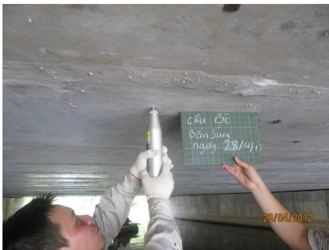
Thí nghiệm, kiểm định thử tải cầu Ốc thành phố Nam Định Construction quality control, loading test Oc Bridge, Nam Dinh Province
