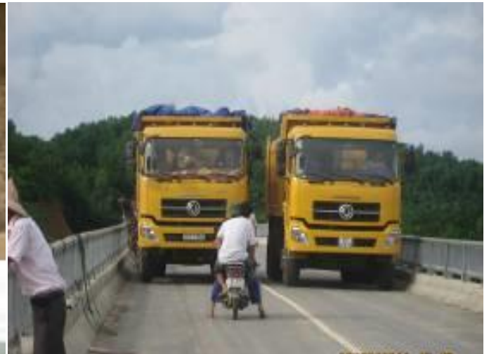
Thí nghiệm, kiểm định, thử tải Dự án cầu Cây Chanh tỉnh Nghệ An Construction quality control, loading test Cay Chanh Bridge, Nghe An Province
