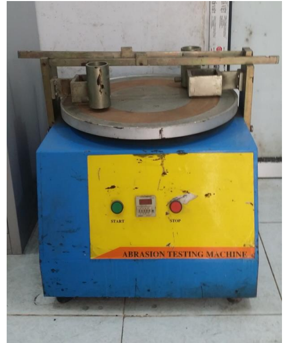
Hình 42. Máy thí nghiệm độ mài mòn của gạch và bê tông Figure 42. Abrasion testing machine
