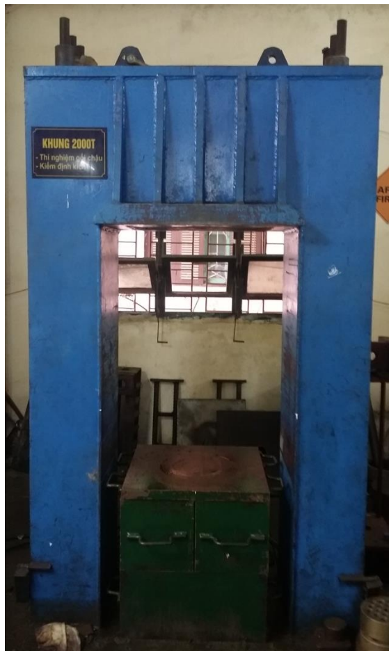
Hình 45. Khung thí nghiệm gối cầu 2000T Figure 45. Compression of Bearing test frame 2000T
