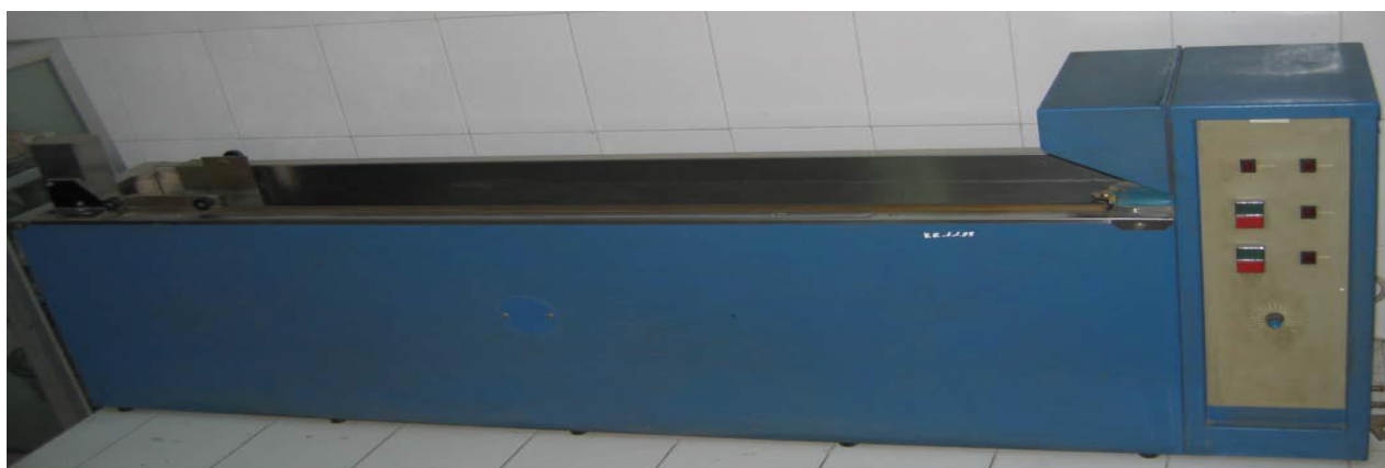
Hình 11. Máy thí nghiệm độ kéo dài, độ đàn hồi của nhựa đường
