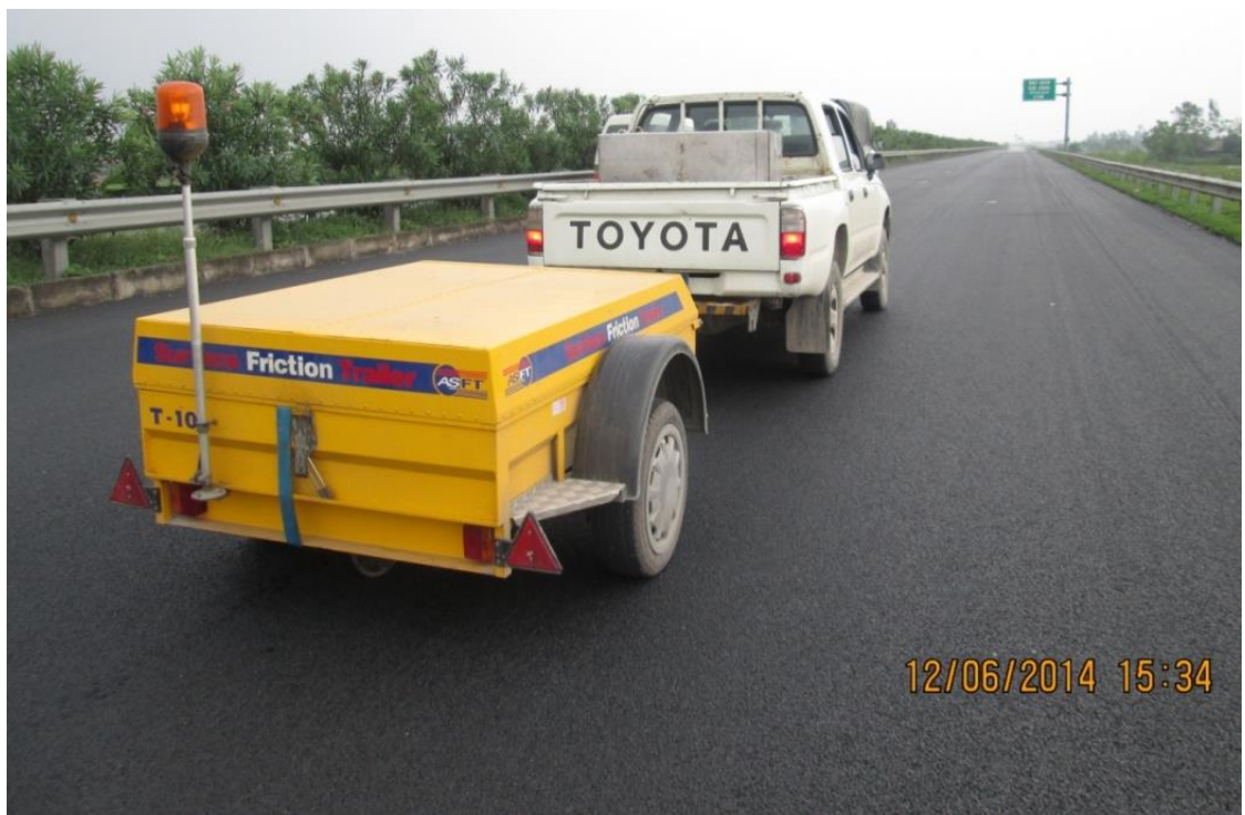
Hình 60. Thiết bị đo sức kháng trượt của mặt đường SFT T-10 Figure 60. Measurement of road surface friction coefficient SFT T-10
