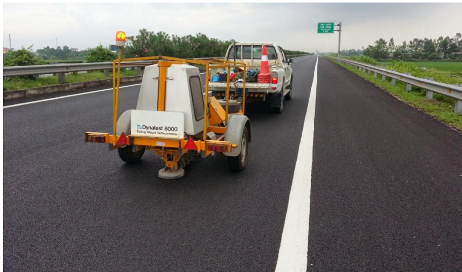
Hình 58. Thiết bị đo mô đun đàn hồi bằng phương pháp động FWD Figure 58. Elastic modulus of pavement by FWD machine
