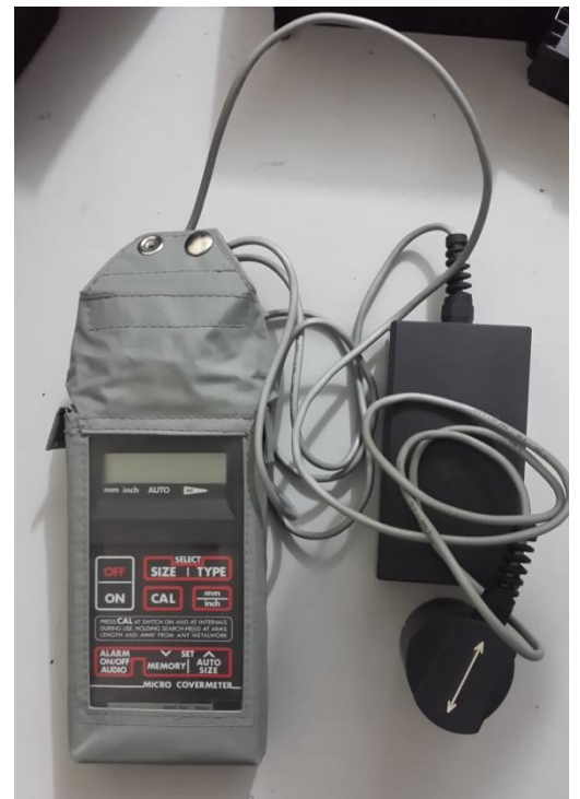
Hình 48. Thiết bị xác định đường kính cốt thép Electromagnetic method for determining location and diameter of steel bar in the concrete
