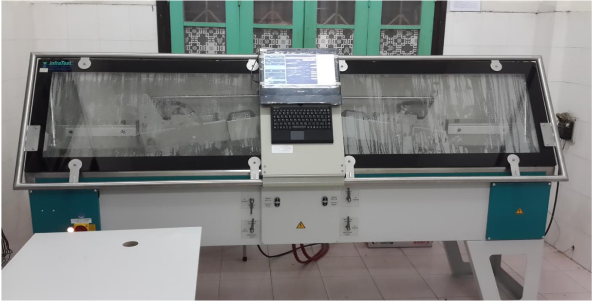
Hình 1. Hệ thống thiết bị thí nghiệm hằn lún vết bánh xe Figure 1. Hamburg Wheel-Track Testing of Compacted Hot Mix Asphalt (HMA)
