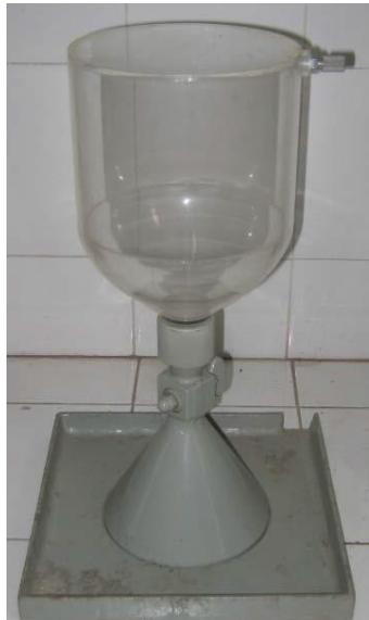
Hình 56. Phễu rót cát thí nghiệm đo độ chặt hiện trường Hình 56. Density of Soil In-Place by the Sand-Cone Method
