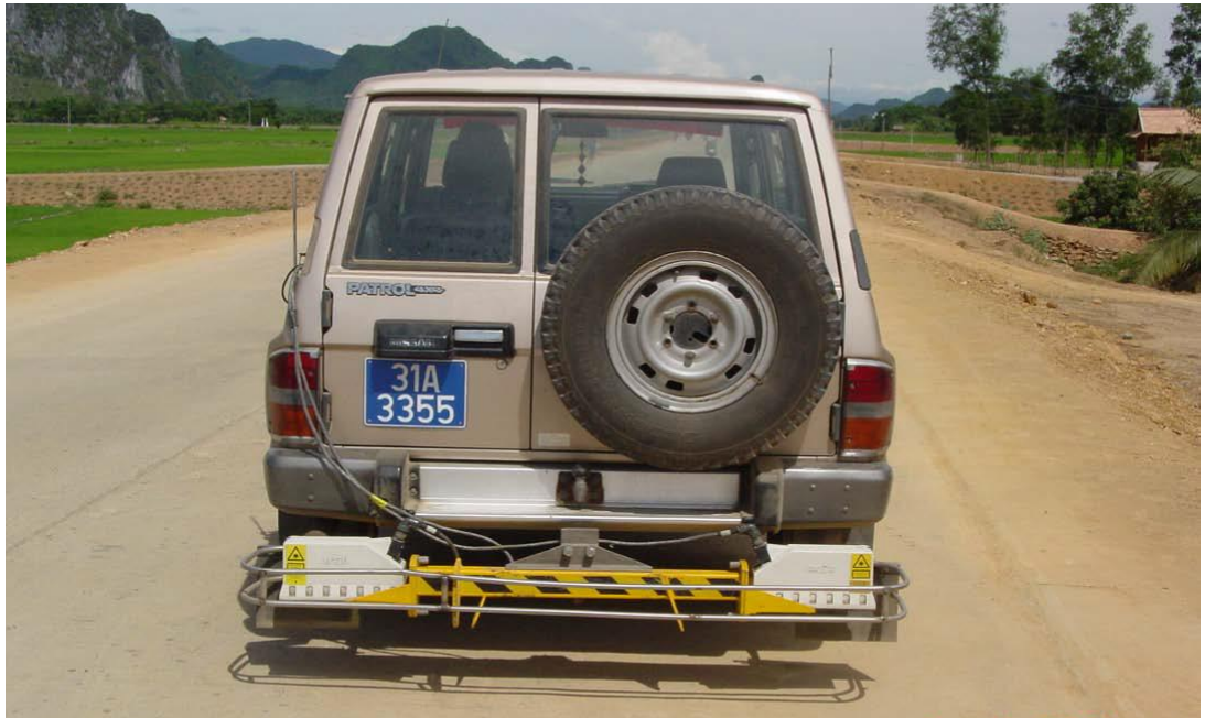
Hình 59. Thiết bị đo độ bằng phẳng IRI (Two laser) lắp trên xe Figure 59. Measuring the Longitudinal Profile of Traveled Surfaces with an Accelerometer Established Inertial Profiling Reference
