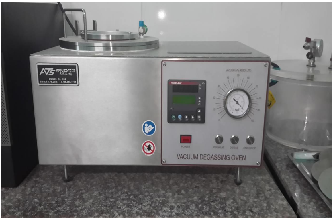
Hình 8. Bộ thiết bị tủ hút chân không già hóa nhựa đường
