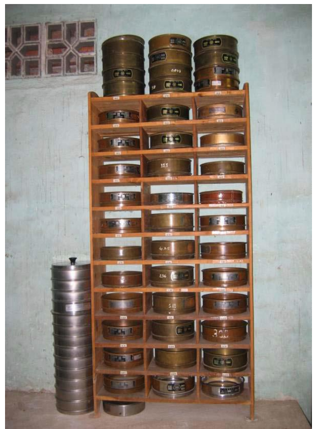
Hình 19. Bộ sàng tiêu chuẩn phân tích thành phần hạt của vật liệu Figure 19. Sieve set for determine Particle Size Analysis of Material
