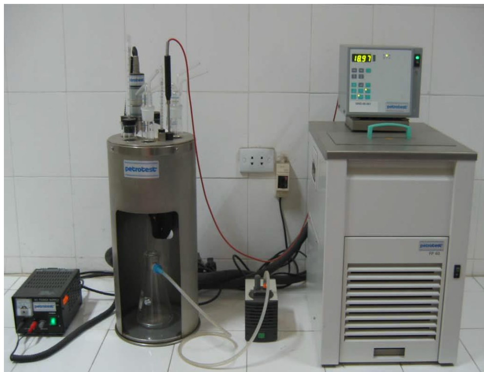
Hình 14. Bộ thiết bị xác định hàm lượng Paraffin có trong nhựa đường Figure 14. Paraffin wax testing system (PETROTEST)
