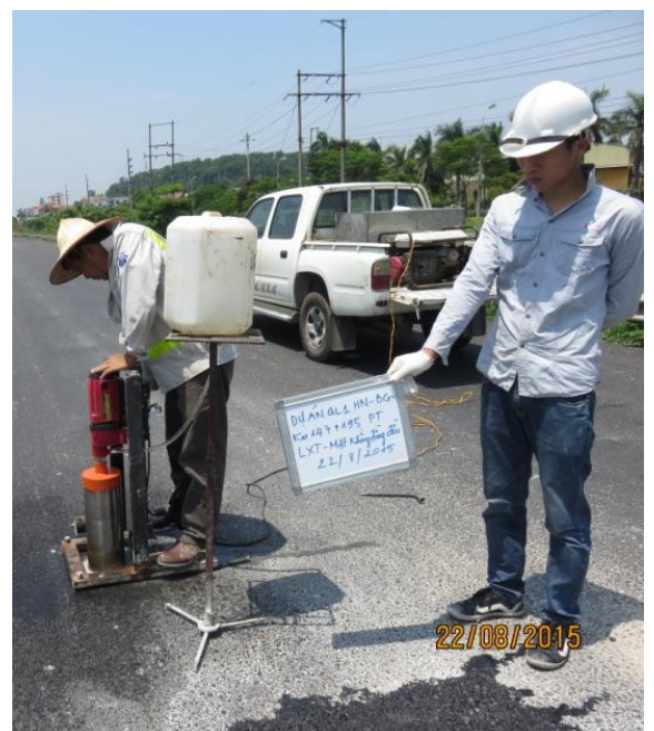
Hình 53. Máy khoan mẫu tại hiện trường Figure 53. Sample drilling machine at site
