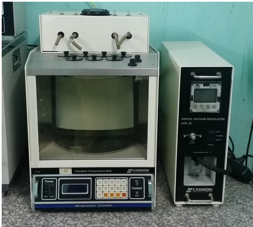
Hình 9. Thiết bị thí nghiệm độ nhớt động lực học của nhựa đường
