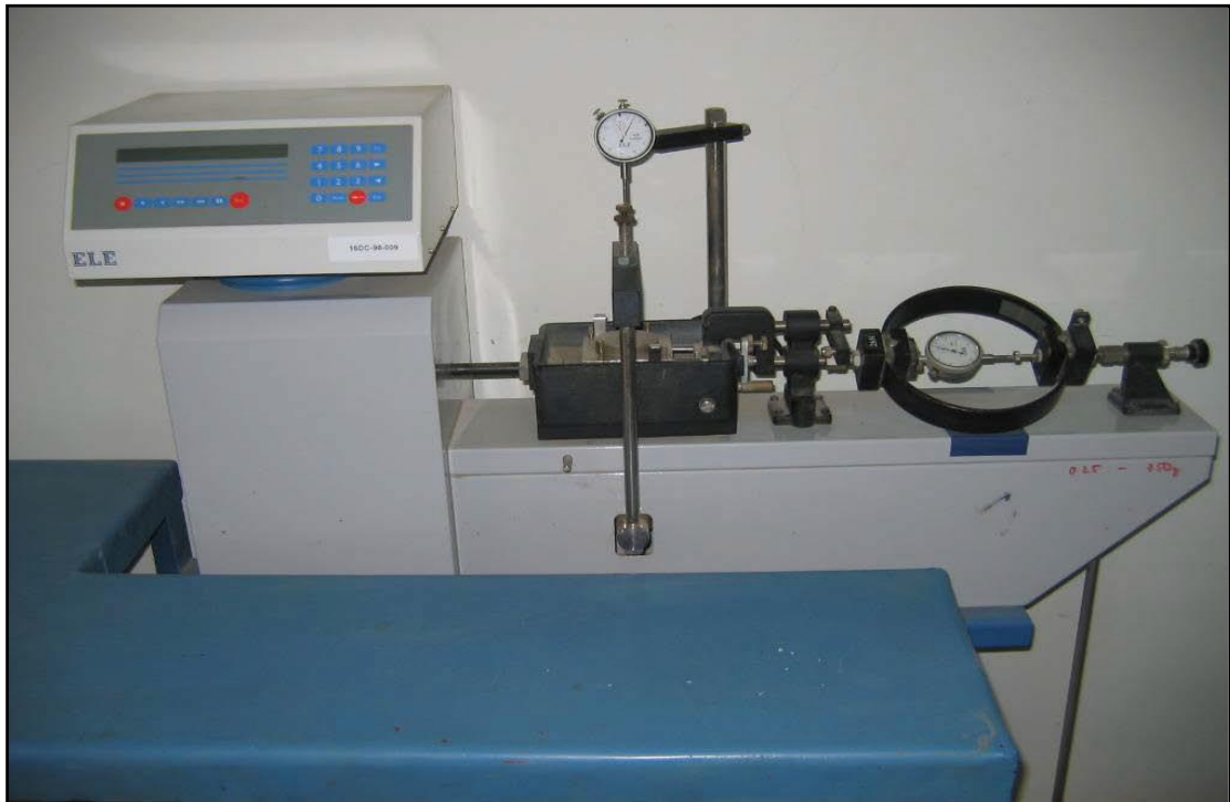
Hình 25. Thiết bị thí nghiệm cắt phẳng tự động ELE Figure 25. Direct /Residual shear apparatus (ELE)
