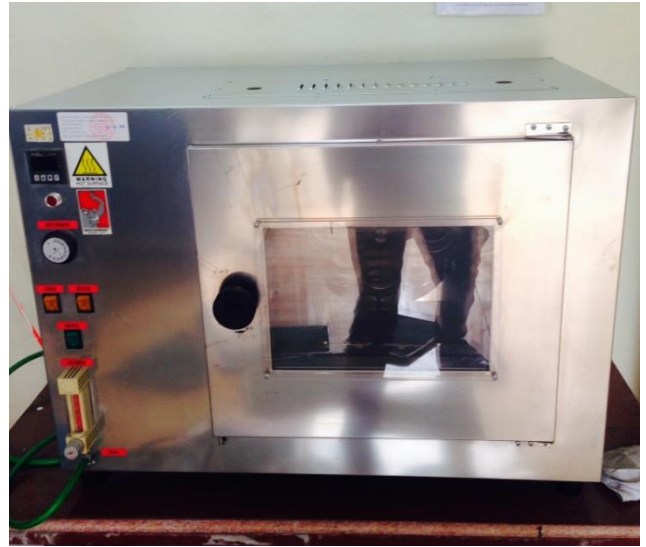
Hình 6a. Thí nghiệm gia nhiệt màng mỏng bitum trên thiết bị xoay Figure 6a. Experiment on bitumen thin film heating on rotating equipment
