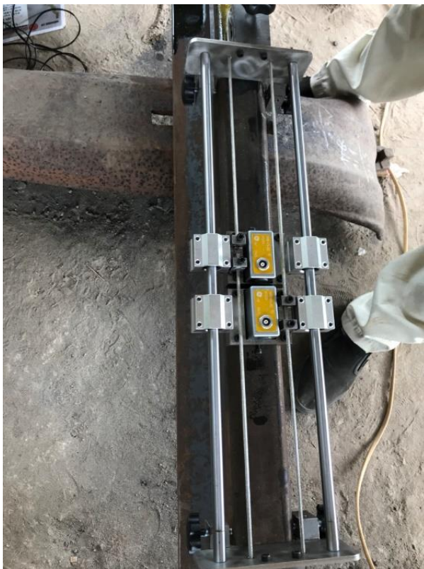
Hình 67. Khung tadem định hướng đầu dò Figure 67. Mechanical rig to assist the positioning of the probes
