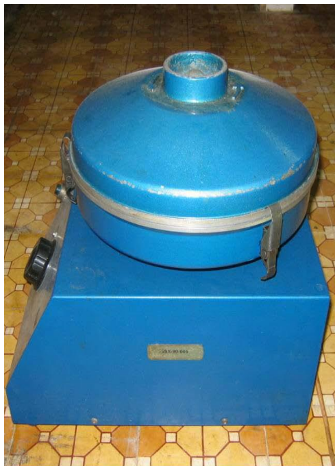
Hình 21. Thiết bị thí nghiệm tách nhựa Rotatest Figure 21. Asphalt centrifuge extractor
