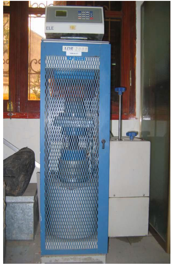
Hình 32. Máy thí nghiệm cường độ kháng nén ELE Figure 32. Compressive strength test ELE
