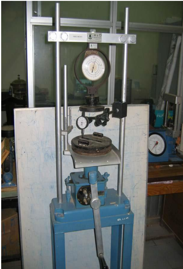
Hình 31. Thiết bị thí nghiệm nén một trục Figure 31. Unconfined Compressive Strength Tester
