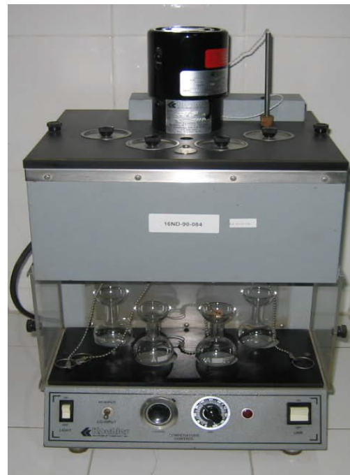
Hình 22. Thiết bị thí nghiệm xác định độ nhớt của nhũ tương Figure 22. Determination of Viscosity of emulsified bitumen
