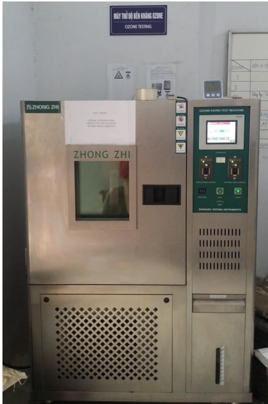
Hình 37. Máy thí nghiệm độ bền kháng Ozone Figure 37. Ozone testing
