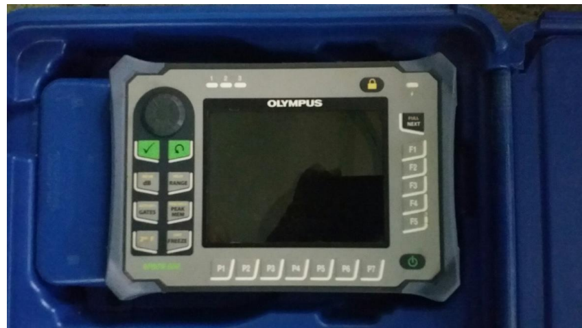
Hình 51. Thiết bị siêu âm mối hàn Figure 51. Ultrasonic weld testing
