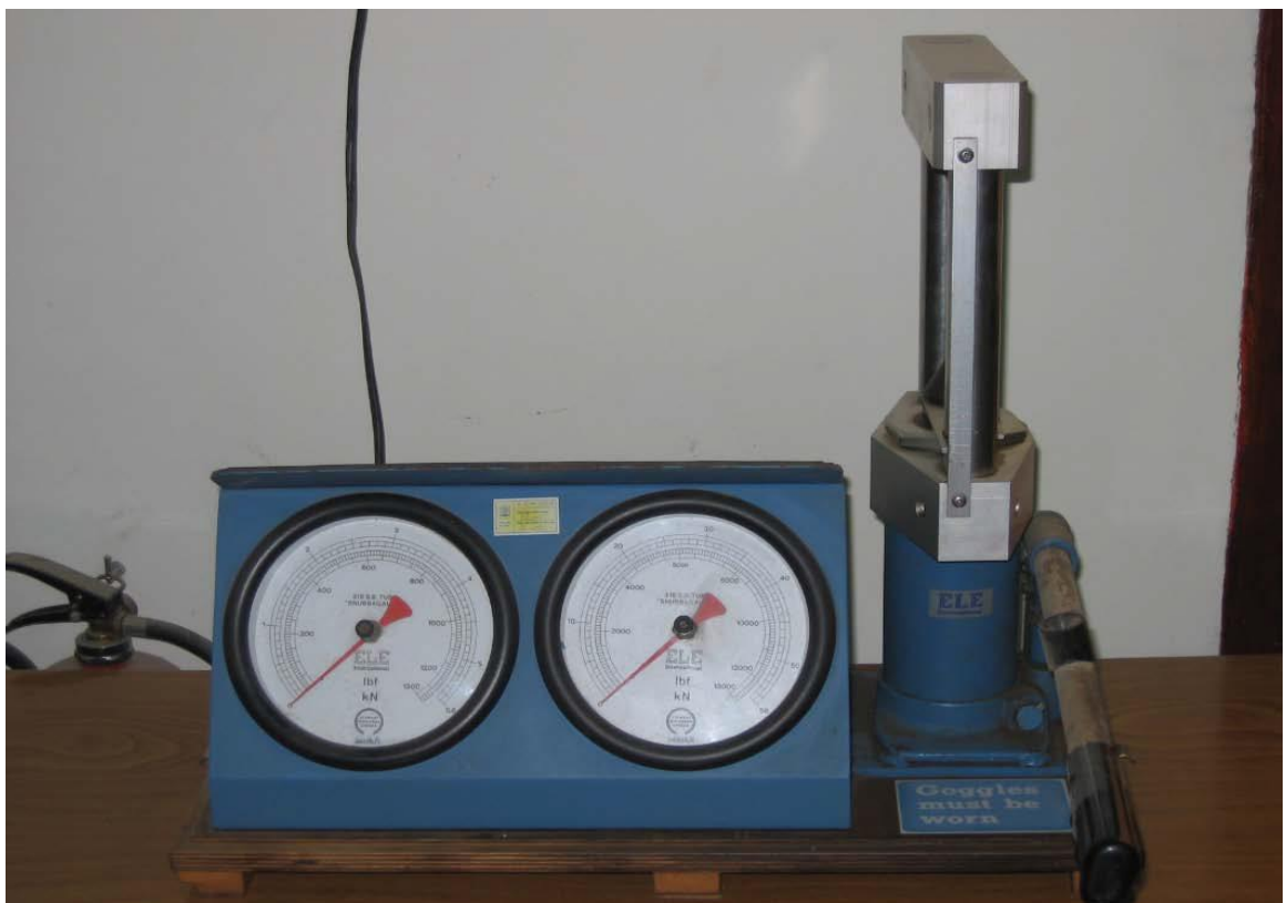
Hình 27. Thiết bị thí nghiệm cường độ nén điểm của đá ELE Figure 27.Point Compressive Strength Tester
