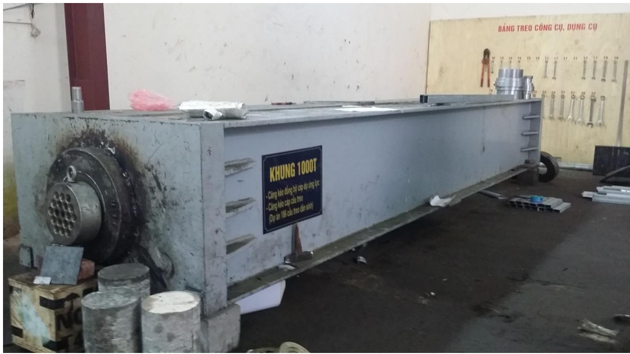
Hình 44. Hệ thống khung căng kéo cáp dự ứng lực Figure 44. Cable test frame
