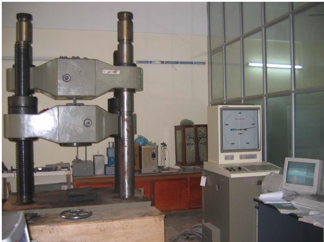
Hình 34. Máy thí nghiệm vạn năng SHIMADZU 2000kN Figure 34. Steel Testing System (2000kN)
