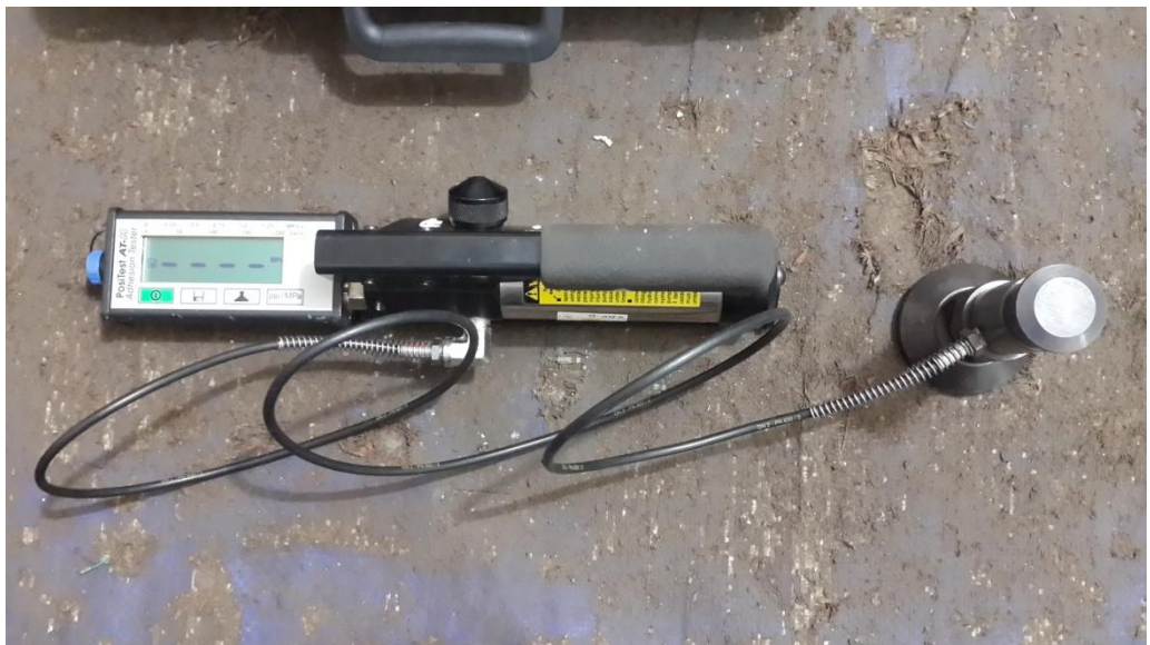
Hình 50. Thiết bị xác định cường độ kéo nhổ (Pull-Off) Figure 50. Determination of nail pull resistance
