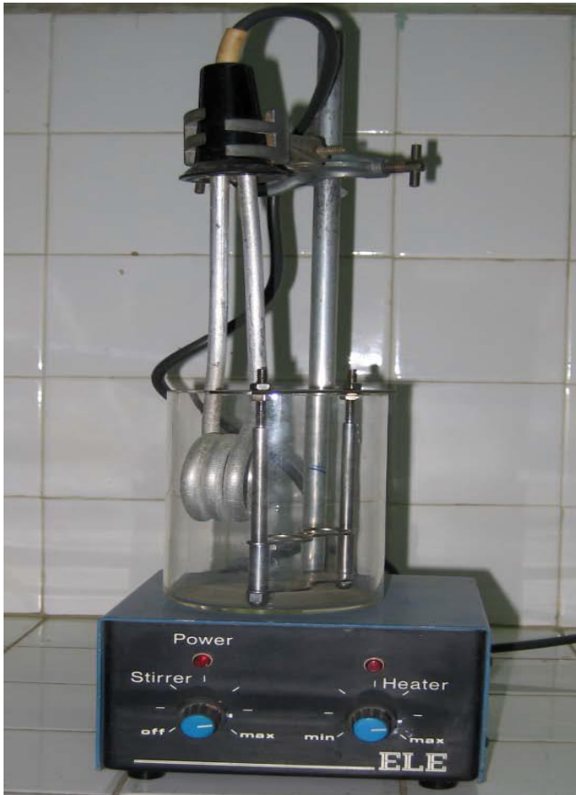
Hình 12. Thiết bị thí nghiệm độ hóa mềm của nhựa đường Figure 12. Ring and ball apparatus ( for Softening coefficient of Bituminous )
