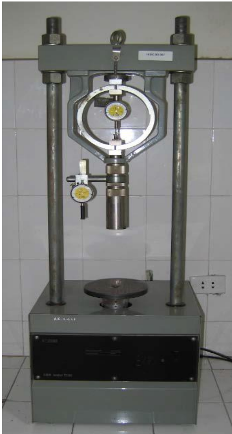
Hình 23. Thiết bị thí nghiệm xác định chỉ số CBR Figure 23. Index of The California Bearing Ratio Testing
