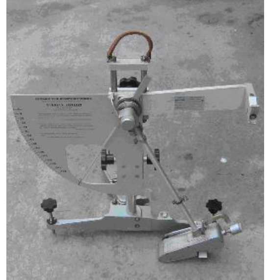
Hình 57. Con lắc Anh thí nghiệm sức kháng trượt của mặt đường Figure 57. Measuring Surface Frictional Properties Using the British Pendulum Tester
