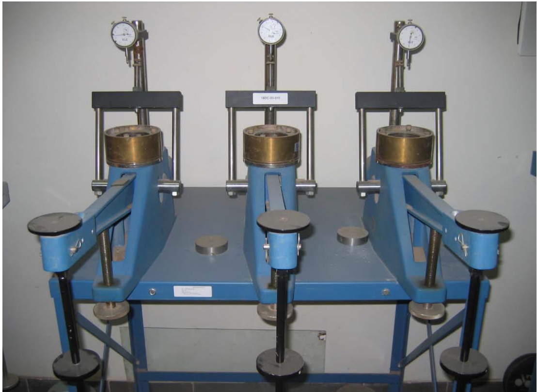
Hình 26. Thiết bị thí nghiệm nén cố kết ELE Figure 26.Consolidation apparatus
