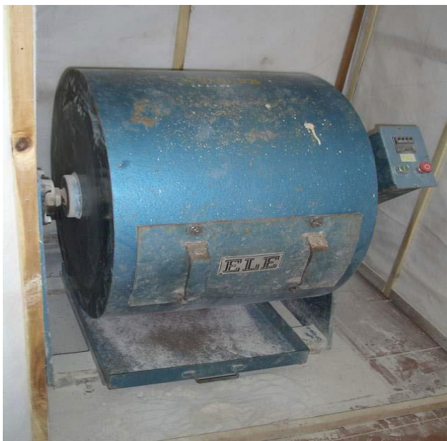
Hình 29. Thiết bị thí nghiệm độ mài mòn LosAngeles ELE Figure 29.Resistance to Degradation of Small Size Coarse Aggregate by Abrasion and Impact in the Los Angeles Machine
