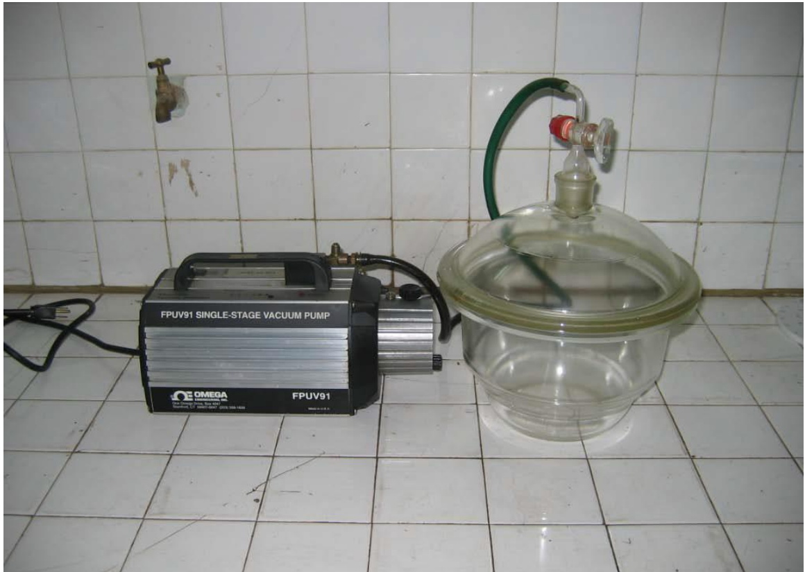
Hình 17. Máy hút chân không Figure 17. Vacuum pyknometer
