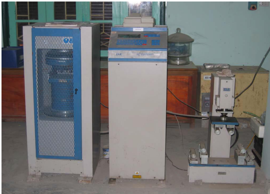
Hình 33. Máy thí nghiệm cường độ vật liệu Bê tông xi măng 3000kN ELE Figure 33. Concrete testing system ( ELE)
