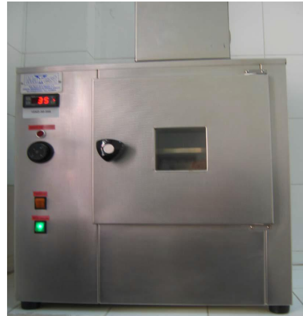
Hình 13. Thiết bị thí nghiệm xác định hàm lượng tổn thất của nhựa đường khi đun nóng Figure 13. Loss on heating/ Thin film oven
