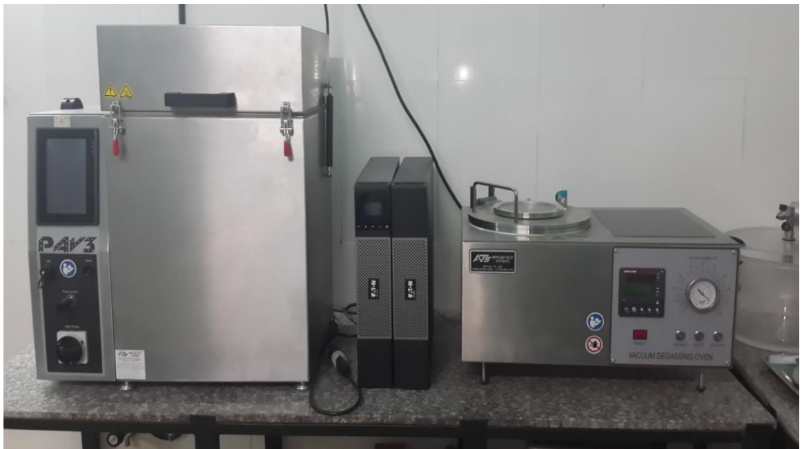
Hình 7. Bộ thiết bị già hóa nhựa đường dài hạn PAV3 Figure 7. Pressure Aging Vessel of Bituminous Materials (PAV)
