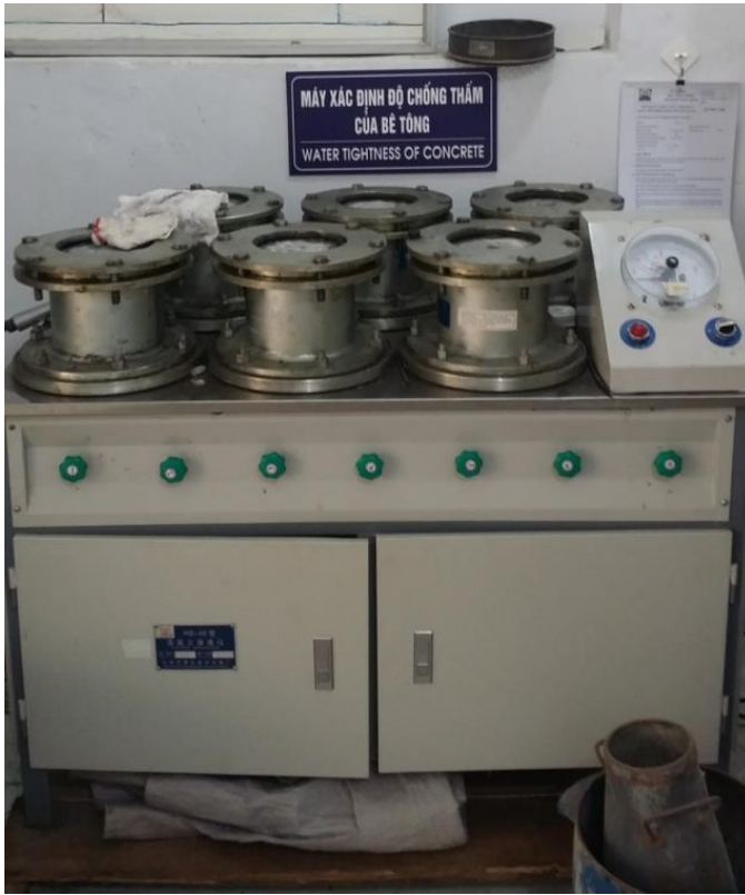
Hình 41. Máy thí nghiệm độ chống thấm của bê tông Figure 41. Waterproof testing machine of concrete
