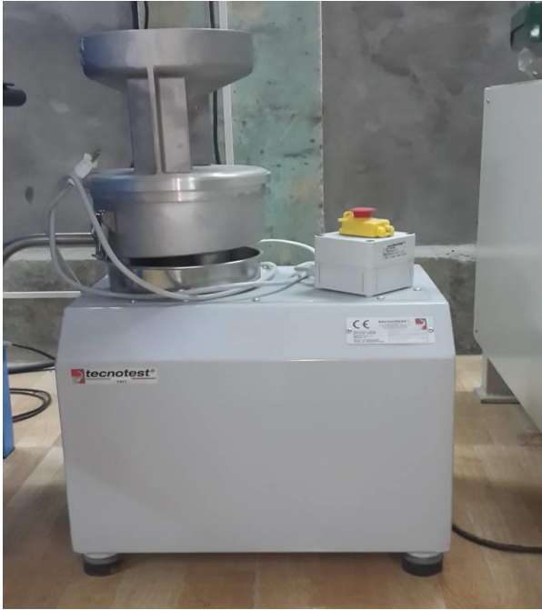
Hình 6. Thiết bị tách bột khoáng từ dung dịch triết tách (Abson) Figure 6. Equipment for separating mineral powders from extraction solution
