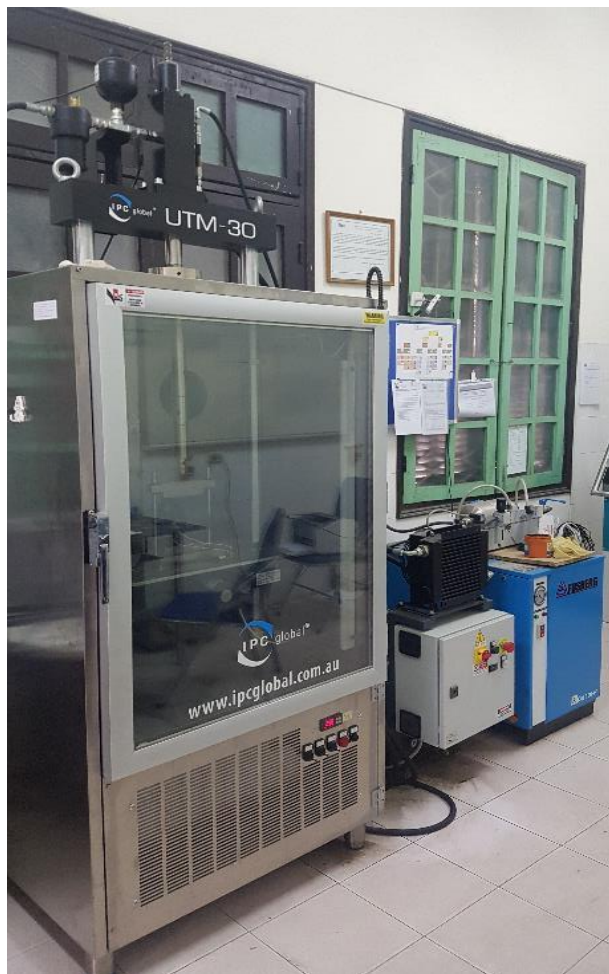
Hình 2. Hệ thống thiết bị thí nghiệm mô đun đàn hồi động của vật liệu (UTM-30) Figure 2. Modulus of dynamic elasticity (UTM-30)
